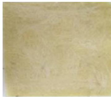
Placa de material compuesto fabricado con matriz de epoxi reforzado con fibras largas de henequén orientadas aleatoriamente (Rodríguez Soto *et al.*, 2015).
